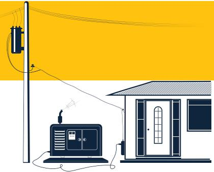
Es aconsejable que al instalar un generador de emergencia, se utilice un interruptor de transferencia manual o automático para aislar el sistema eléctrico del generador del sistema de la AEE. De esta forma se evitan accidentes eléctricos mayores.
